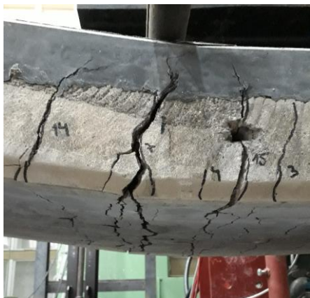
Obrázek 7: Trhliny po zničení panelu s 50- m0 mm UHPC ( jpg file )
