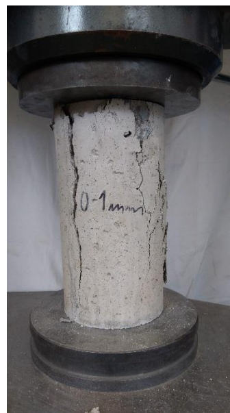
Obrázek 5 : Normové porušení vzorku při tlakové zkoušce
