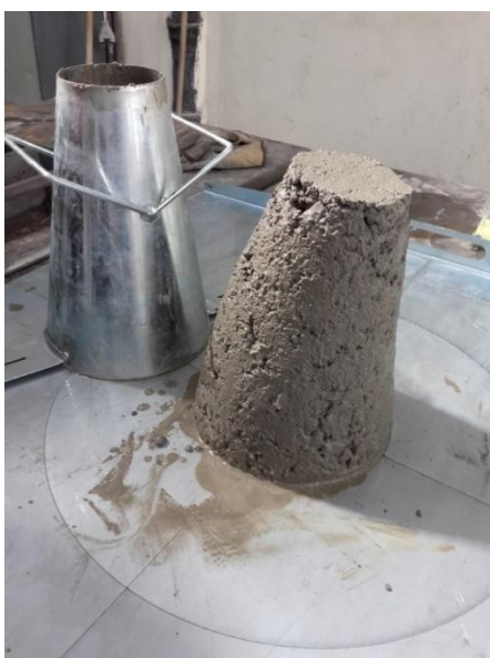
Obrázek 1: Zkouška zpracovatelnosti sednutím kužele.
