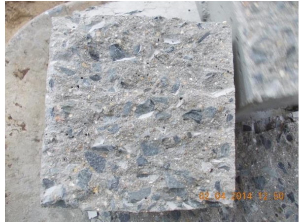
Obrázek 3: Křehké chování krychle z prostého betonu
