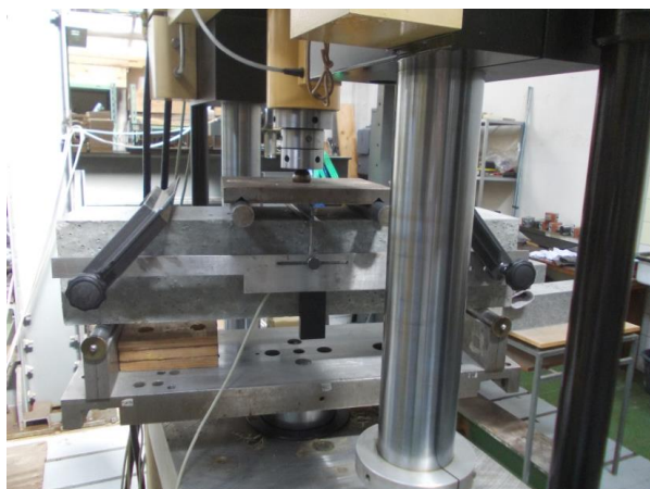
Obrázek 9: Zkouška v tahu za ohybu při čtyřbodovém uspořádání
