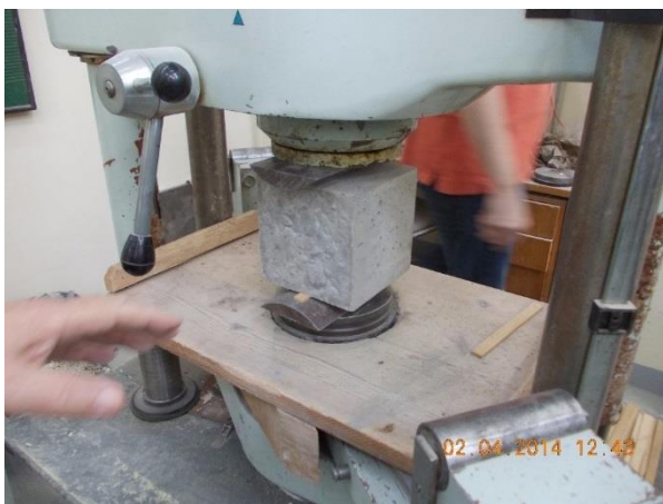
Obrázek 2: Zkouška v příčném tahu na krychlích
