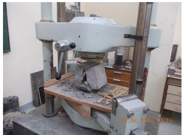
Obrázek 4: Duktilní chování krychle z drátkobetonu
