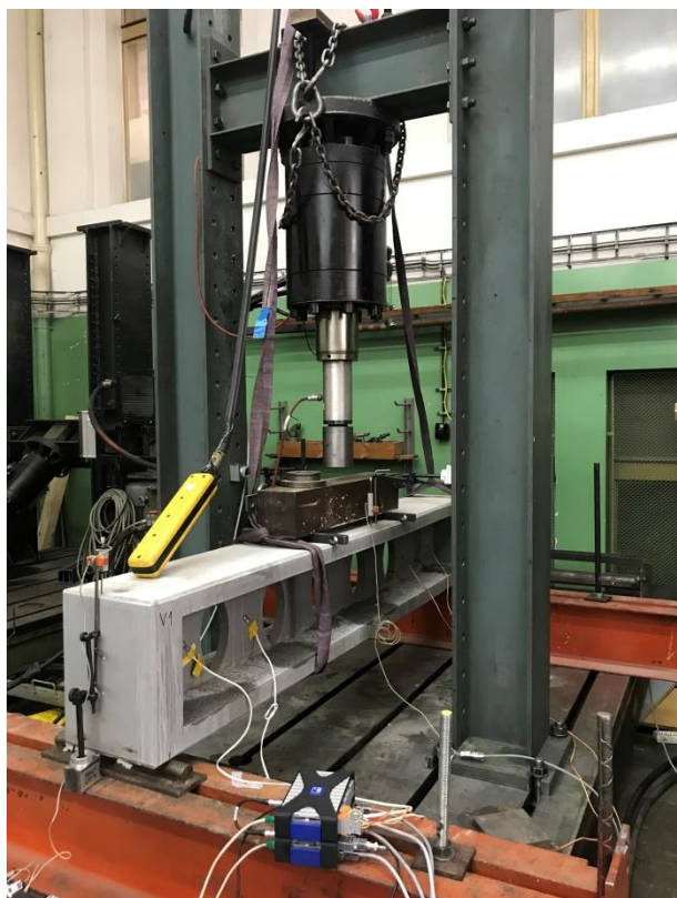
Obr. 6: Vybetonovaný nosník při zatěžování
