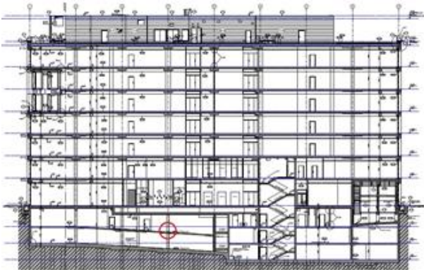
Obrázek 2: Půdorys budovy s vyznačenou polohou tenzometrů.
