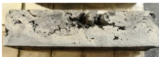
Obrázek 1: Špatně zhutněný vzorek mikrosiliky.
