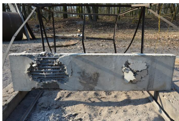
Obrázek 13: Poškození dolního povrchu kompozitu, experimentální měření.
