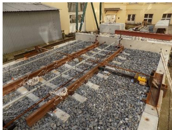
Obrázek 2: Zatěžování modelu bezстыkové koleje při měření příčného odporu koleje
