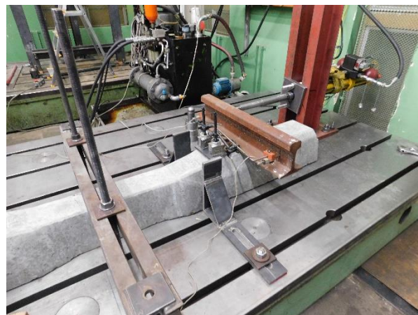
Obrázek 4: Pohled na zkoušené upevňovadlo včetně zatěžovacího lisu a měřících snímačů
