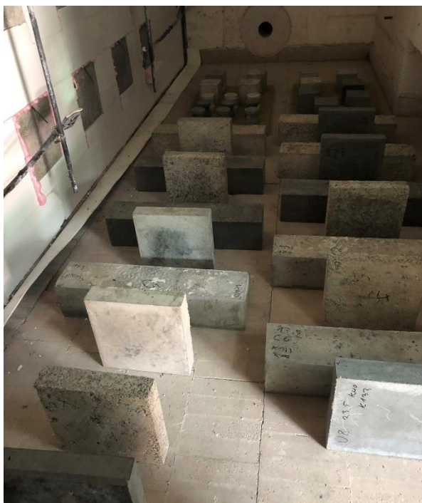
Obrázek 3 Rozmístění vzorků ve zkušební peci
