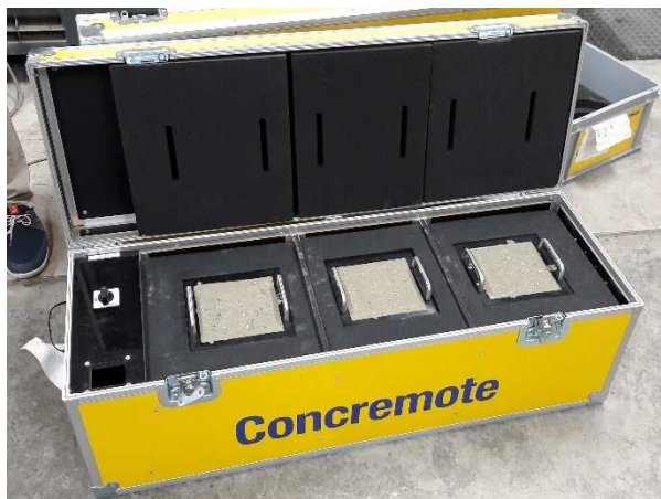
Obrázek 7: Právě vytvořené vzorky v kalibračním boxu
