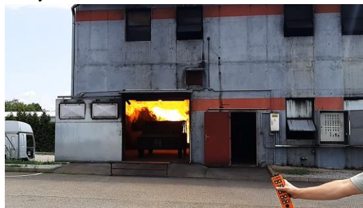
Obrázek 3: Požární zkouška v garáži (Procházka a kol., 2019).
