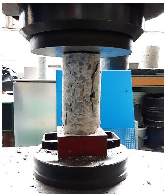
Obrázek 7: Destruktivní zkouška tlakové pevnosti betonového vývrhu odebraného ze stěny OD (Procházka a kol., 2019).
