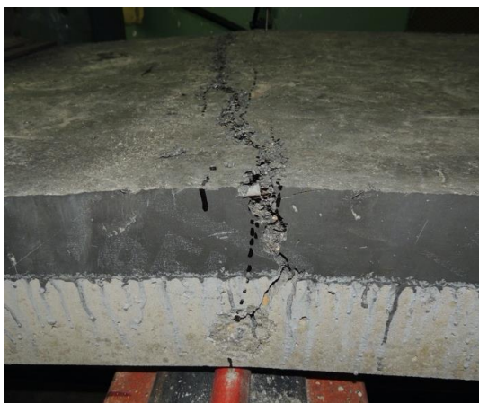
Obrázek 7: Porušení panelu s 50 mm UHPC.
