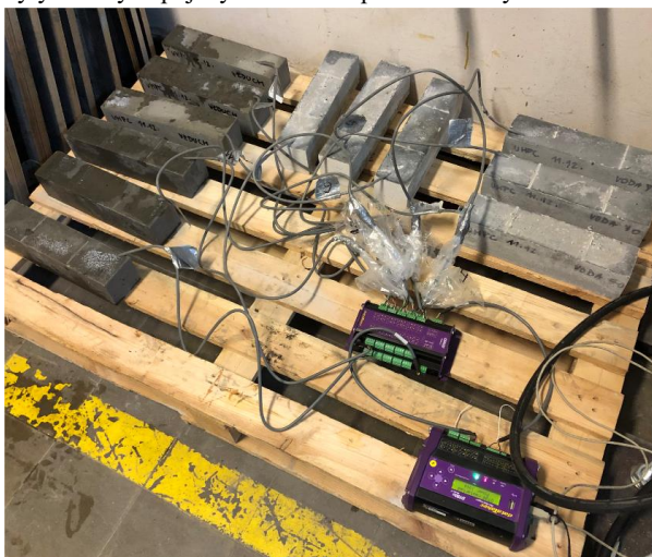
Obr. 3: Měření přetvoření vzorků po ukončení ošetřování.
