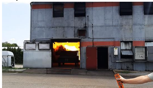
Obrázek 3: Požární zkouška v garáži (Procházka a kol., 2019).
