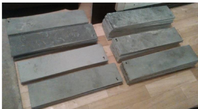
Obrázek 2: Zkušební vzorky: vlevo – zkušební krychle; vpravo – vzorky z textilního betonu.
