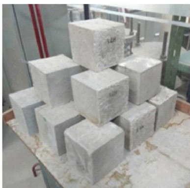
Obrázek 2: Zkušební vzorky: vlevo – zkušební krychle; vpravo – vzorky z textilního betonu.
