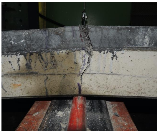
Obrázek 6: Porušení panelu s 30 mm UHPC.
