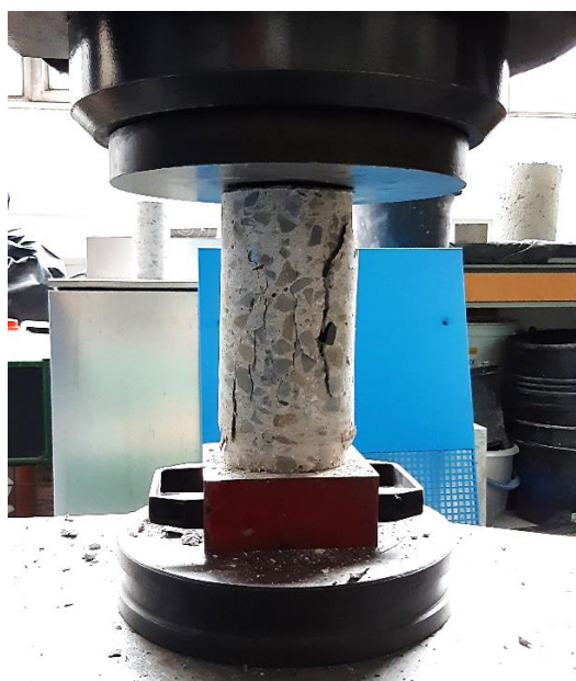
Obrázek 7: Destruktivní zkouška tlaková pevnosti betonového vývrtu odebraného ze stěny OD (Procházka a kol., 2019).
