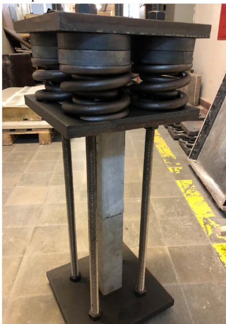
Obr. 4: Umístění trámků pro měření dotvarování do standů s pružinami.
