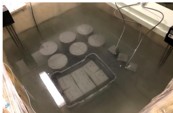
Obr. 1: Sada vzorků v průběhu ošetřování.
