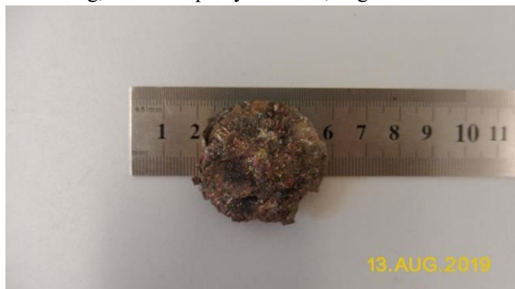
Obrázek 13 : Projektil po výbuchu
