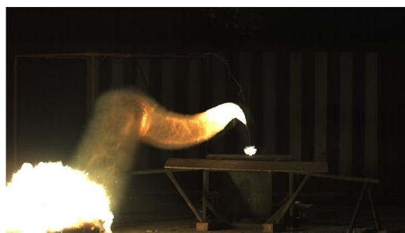
Obrázek 1: Záběr při detonaci. V levé části je primární zdroj osvětlení – hliníkový prášek
