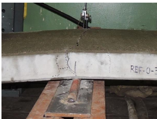
Obrázek 5: Porušení referenčního panelu.
