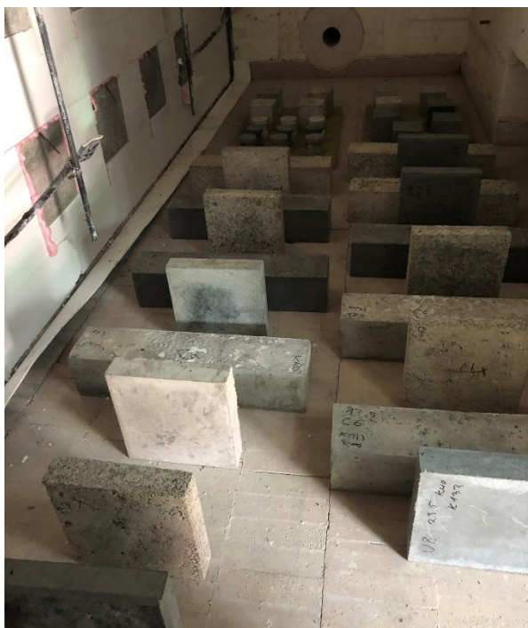
Obrázek 3 Rozmístění vzorků ve zkušební peci
