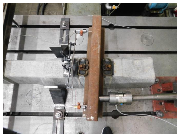
Obrázek 3: Schéma uspořádání experimentu na stanovení torzní tuhosti upevňovadla
