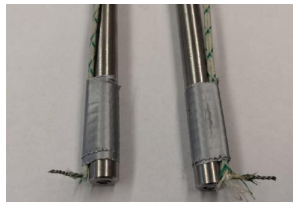
Obrázek 5: Zakončení přenosové trubičky s termočlánkem
