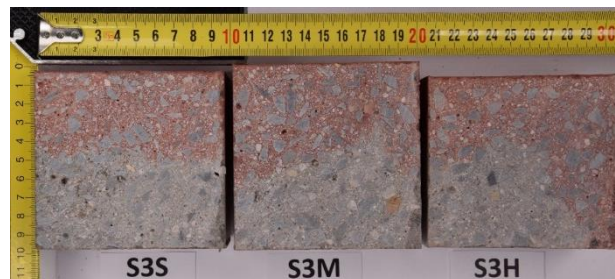
Obrázek 8: Vzorky konzistence S3 seřazené podle frekvence hutnění – příčný řez.
