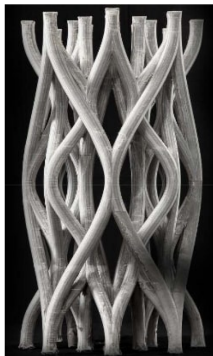
Obr. 10: Betonový prototyp tištěný do 0,1 mm tenkého bednění
