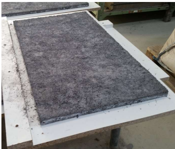
Obrázek 1: Lehká drátkobetonová deska bez povrchové úpravy
