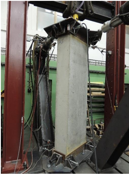
Obrázek 2: Zkoušení vzorku s přtlakem
