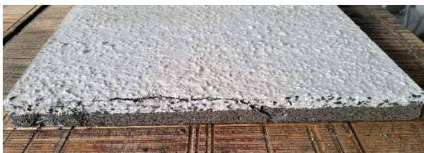
Obrázek 5: Řez deskou v místě porušení
