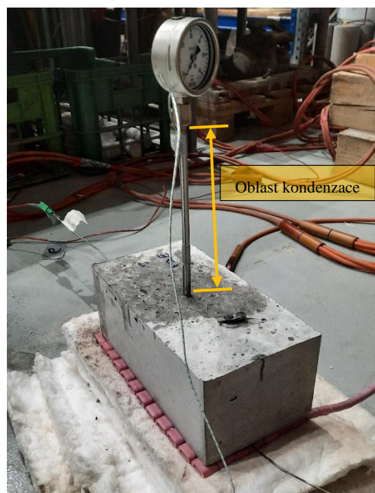
Obrázek 7: Vzorek během měření pórového tlaku
