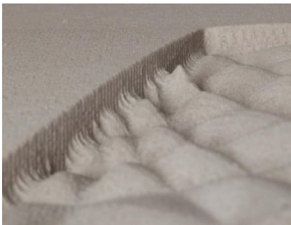
Obr. 4: Zmražený písek, vytvarován pomocí CNC obráběcího stroje
