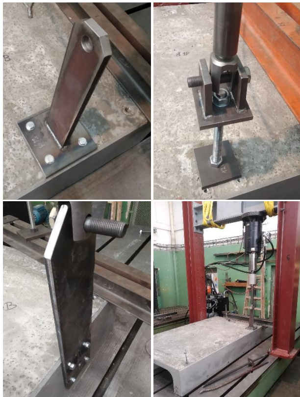
Obrázek 4: Zkušební přípravky ke spojení válce se vzorkem
