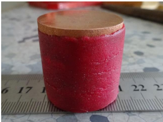
Obrázek 3 : Ručně lisovaný semtex, měděný projektil
