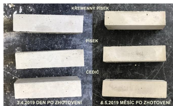
Obrázek 11: Porovnání všech vzorků s různým kamenivem
