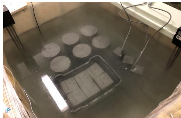
Obr. 3: Sada vzorků v průběhu ošetřování.
