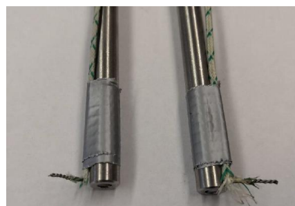
Obrázek 5: Zakončení přenosové trubičky s termočlánkem
