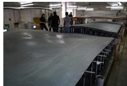
Obr. 5: Flexibilní bednění s označením D300 od firmy Adapa
