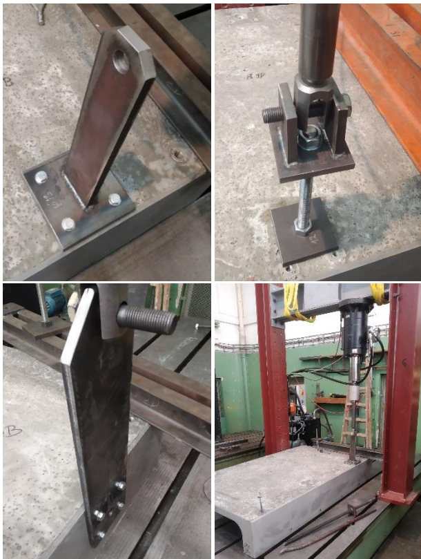
Obrázek 4: Zkušební přípravky ke spojení válce se vzorkem
