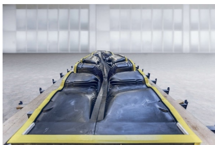
Obr. 9: 3D tištěné bednění technologií binder jetting
