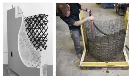
Obr. 11: 3D tištěná matice jako ztracené bednění i výztuž
