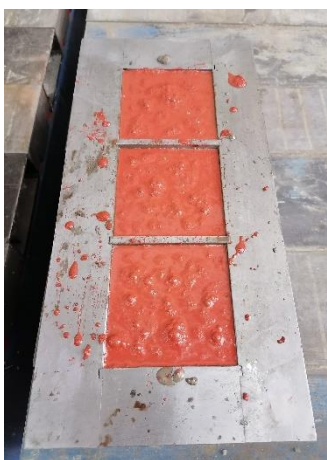
Obrázek 3: Plně naplněná forma barevným betonem s pigmentem.
