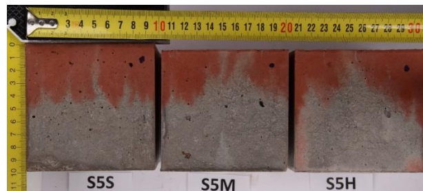
Obrázek 4: Vzorky konzistence S5 seřazené podle frekvence hutnění – fotografie vnějšího povrchu stěn.
