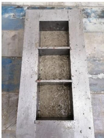
Obrázek 2: Forma naplněná do poloviny výšky šedým prostým betonem.
