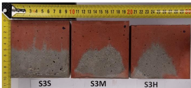
Obrázek 5: Vzorky konzistence S3 seřazené podle frekvence hutnění – fotografie vnějšího povrchu stěn.
