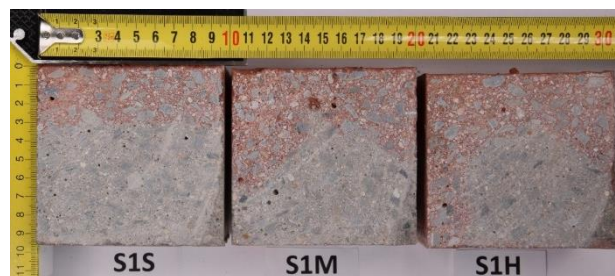
Obrázek 9: Vzorky konzistence S1 seřazené podle frekvence hutnění – příčný řez.
