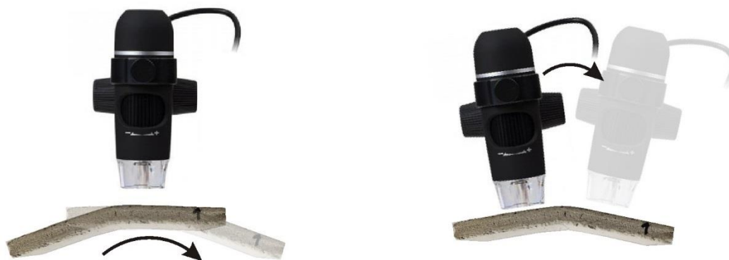
Obrázek 5: Vyhodnocování zakřiveného vzorku.
