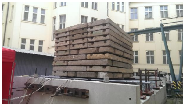
Obrázek 3: Pohled na vertikálně zatížený model koleje
