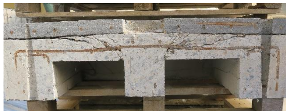
Obrázek 6: Zesílený vzorek po exp. (50 mm UHPC)
