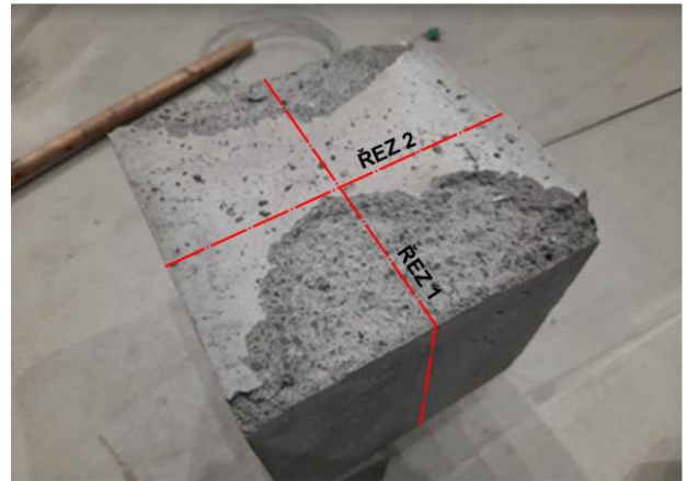
Obrázek 3: Vzorek po odštěpování během zahřívání
