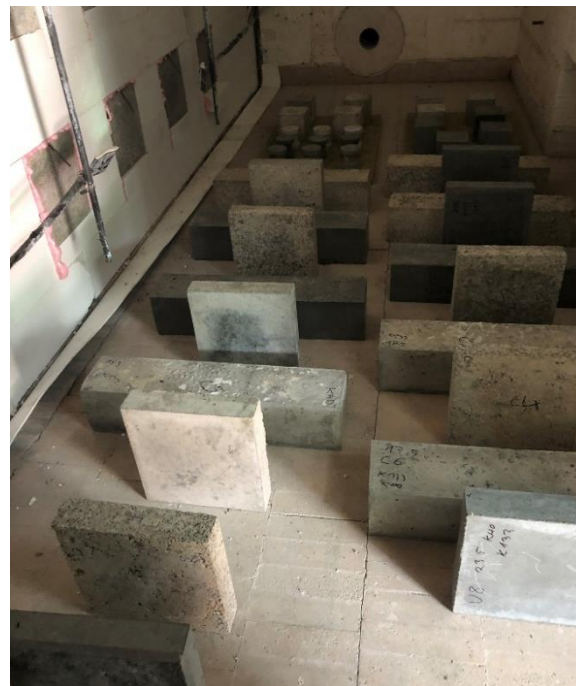
Obrázek 2 Rozmístění vzorků ve zkušební peci
