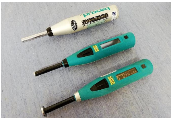
Obrázek 2 – Odrazové tvrdoměry: Schmidt N, SilverSchmidt N, SilverSchmidt L s hříbovým nástavcem [Foto: autor]
