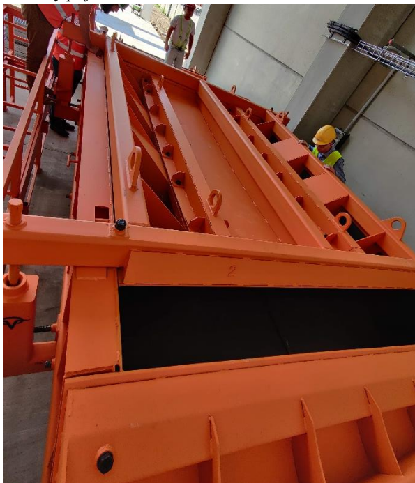
Obrázek 4: Forma s namontovaným záklopem
