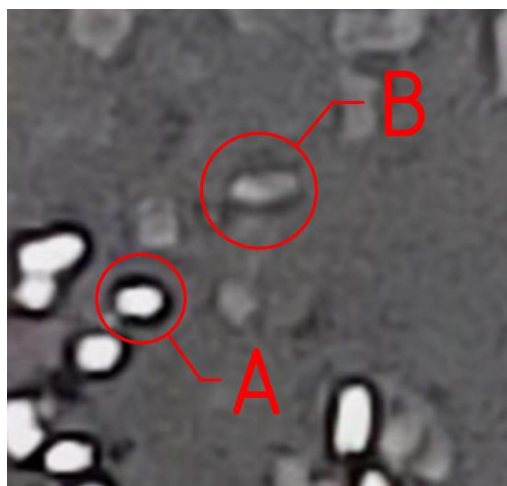
Obrázek (3) – srovnání drátku (A) a kameniva (B)
