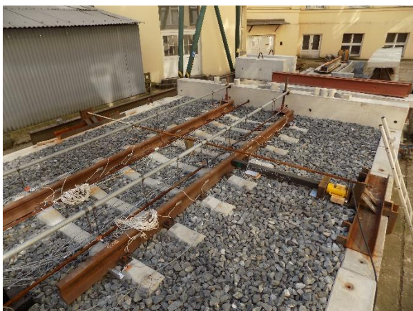
Obrázek 1: Model bezстыkové koleje při měření kolejového roštu v příčném směru
