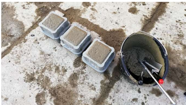
Obrázek 6 - Vytváření zkušebních vzorků [Foto: autor]
