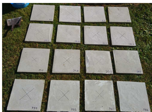
Obrázek 13: Vzorky po odbednění
