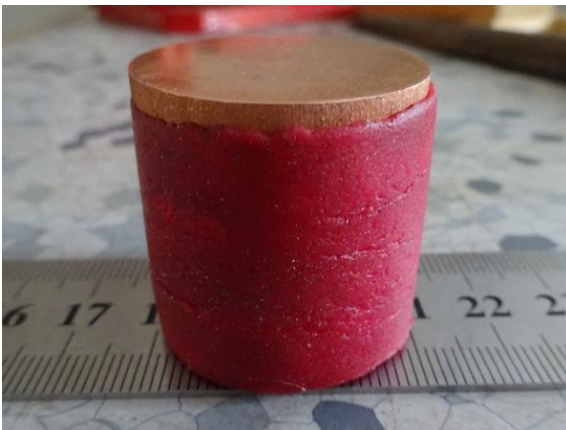
Obrázek 3 : Ručně lisovaný semtex, měděný projektil
