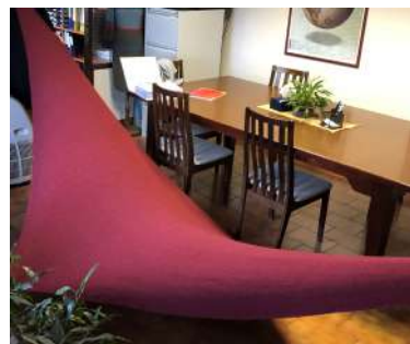
Obr. 7: První pokus strojově pletného prvku
