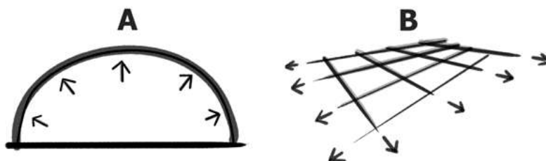
Obr. 2: Vnesení předpětí do membrány
