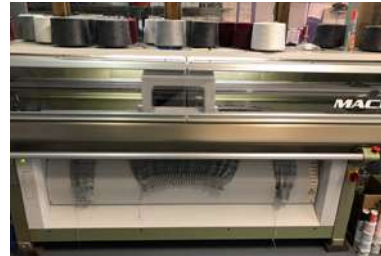
Obr. 3: Pletací stroj v procesu pletení bezešvého svetry
