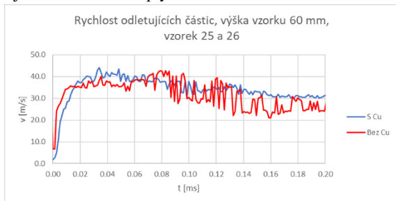
Obrázek 7 : Porovnání rychlosti odletujících částic vzorků 25 a 26
