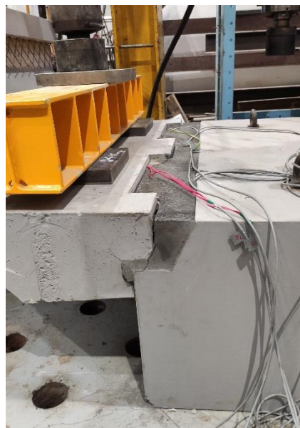
Obrázek 12: Rozevření trhliny u prvního vzorku
