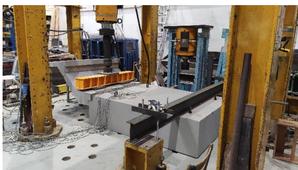
Obrázek 9: Uspořádání zatěžovací zkoušky
