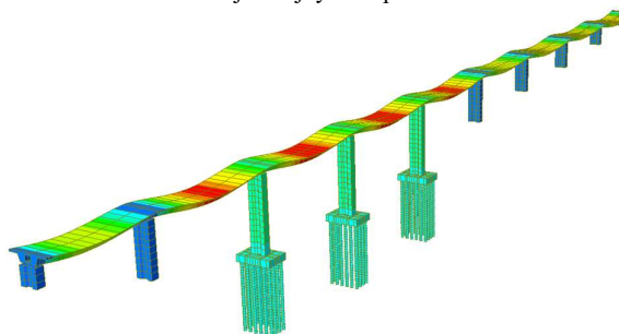
Obrázek 13: Výpočetní model s pružným pilotovým založením
