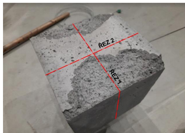
Obrázek 3: Vzorek po odštěpování během zahřívání
