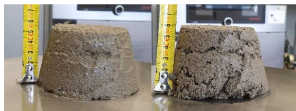
Obrázek 1: Vzorky těsně po sejmutí kužele
