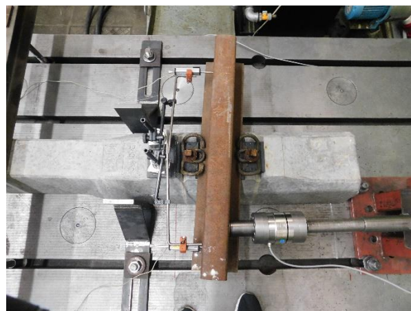
Obrázek 7: Schéma uspořádání experimentu na stanovení torzní tuhosti upevňovačů
