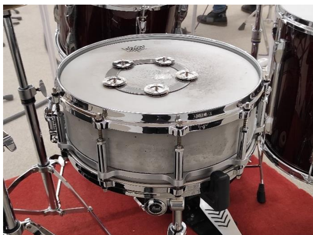
Obrázek 11: Malý buben z UHPC při rozhlasovém natáčení
