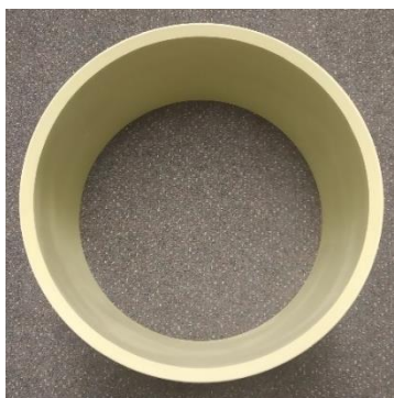
Obrázek 3: Dřevěný korpus pro výrobu formy
