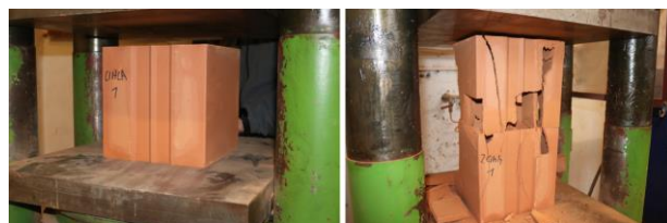
Obrázek 9: Zkouška pevnosti v tlaku inovativní zdící tvarovky a dvou těchto tvarovek spojených „na sucho“
