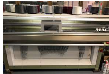
Obr. 3: Pletací stroj v procesu pletení bezešvého svetry
