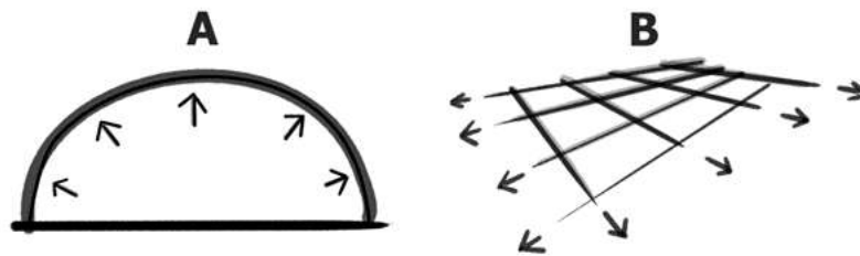
Obr. 2: Vnesení předpětí do membrány
