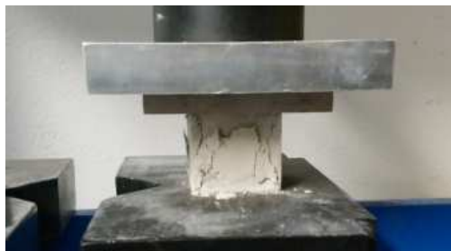
Obrázek 15: Provádění zkoušky pevnosti betonu v tlaku
