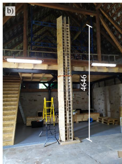
Obrázek 1: Testování vlastností vyvinuté betonové zálivky: a) geometrie betonové nádoby na vyhořelé palivo; b) bednění pro zkoušení vlastností betonové zálivky.
