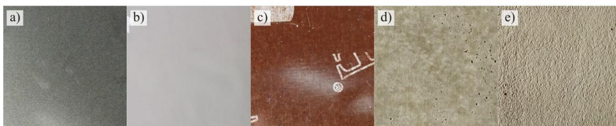
Obrázek 3: Testované materiály: a) ocelový plech; b) plexisklo; c) voděodolná překližka; d) hladký beton; e) hrubý beton.
