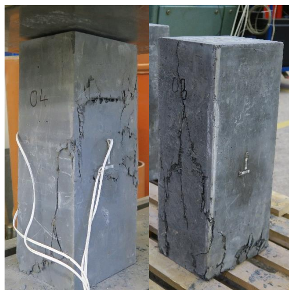
Obrázek 5: Porovnání poškození vzorků – vzorek s výztuží (vlevo) a vzorek bez výztuže (vpravo)
