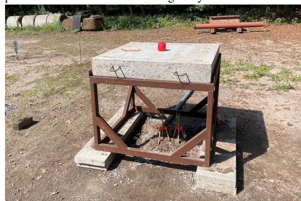
Obrázek 2 – Umístění vzorku před výbuchem
