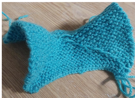
Obr. 4: Ručně pletená 3D pletenina
