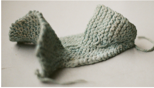
Obr. 8: Hotová miniatura pleteného 3D bednění ztuženého tenkou vrstvou cementové směsi
