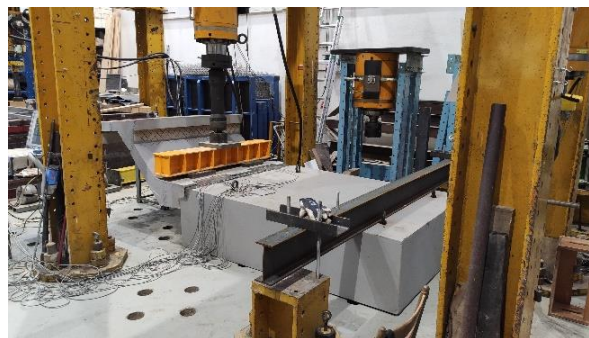
Obrázek 6: Uspořádání zatěžovací zkoušky (Experimentální centrum Fakulty stavební ČVUT v Praze)
