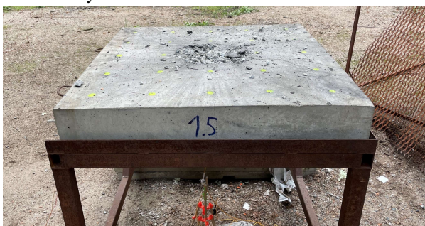
Obrázek 15 - Pohled rovnoběžně se spřahujícími lištami prvku 1.5 (experiment)
