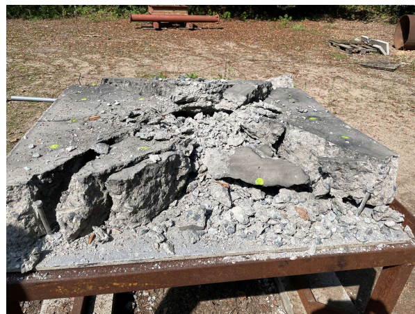
Obrázek 17 - Pohled na porušený vzorek 1.1
