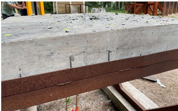
Obrázek 13 - Pohled kolmo na spřahující lišty prvku 1.5 (experiment)
