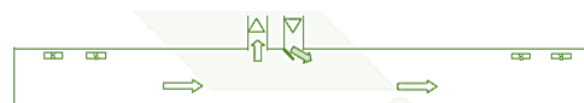
Obr. 4: Druh požárního větrání: podélné větrání s výměnou vzduchu (bodové odsávání a následně vhnání vzduchu skrz injektor) (Metodický pokyn 2013)
