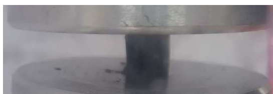
Obrázek 8 - Podrcení vyvýšené hrany vzorku Baryt 10-2
