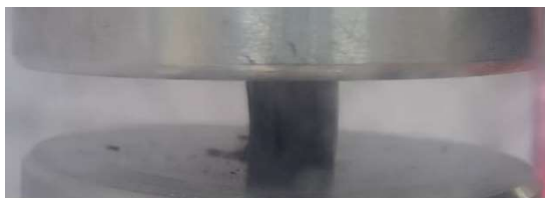
Obrázek 9 - Porušení vzorku Baryt 10-2
