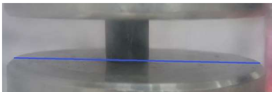
Obrázek 2 - Nerovné podstavy vzorku Serpentinu 1-5
