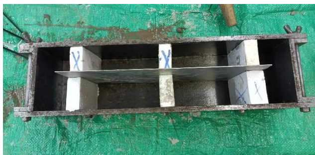
Obrázek 4: Forma pro výrobu vzorků tvaru Z s rozhraním
