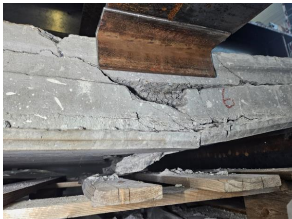
Obrázek 11: Fotografie při kolapsu nasníku a ukončení únavové zatěžovací zkoušky[8]
