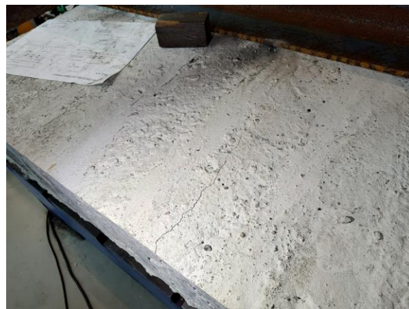
Obrázek 10: Vznik první trhliny během zatěžování panelu při 108000 cyklech a síle v lisu 250 kN
