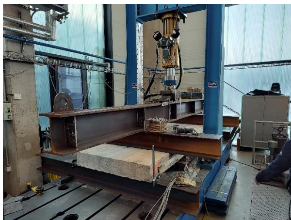
Obrázek 8: Fotografie zkoušeného panelu v lisu před začátkem zatěžování [8]
