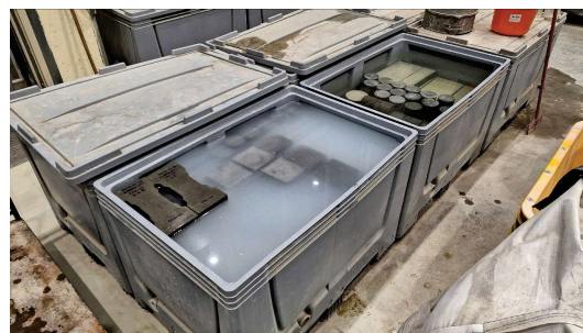
Obrázek 4: Shora: formy naplněné čerstvým UHPC; tělesa po odbednění; ošetřování těles ve vodě.
