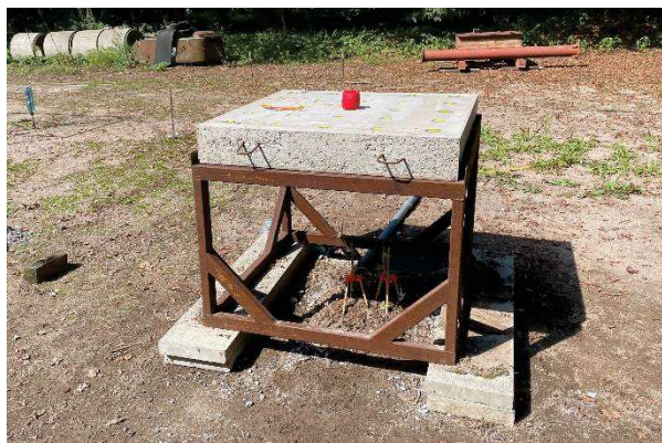
Obrázek 1 – Umístění vzorku před výbuchem
