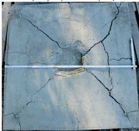
Obrázek 8 - Vzorek 1.2 po experimentu po sundání horní ocel. desky
