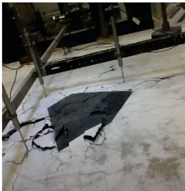
Obr. 05: Detail trhlin desky 2 – nesymetrické poškození [5]
