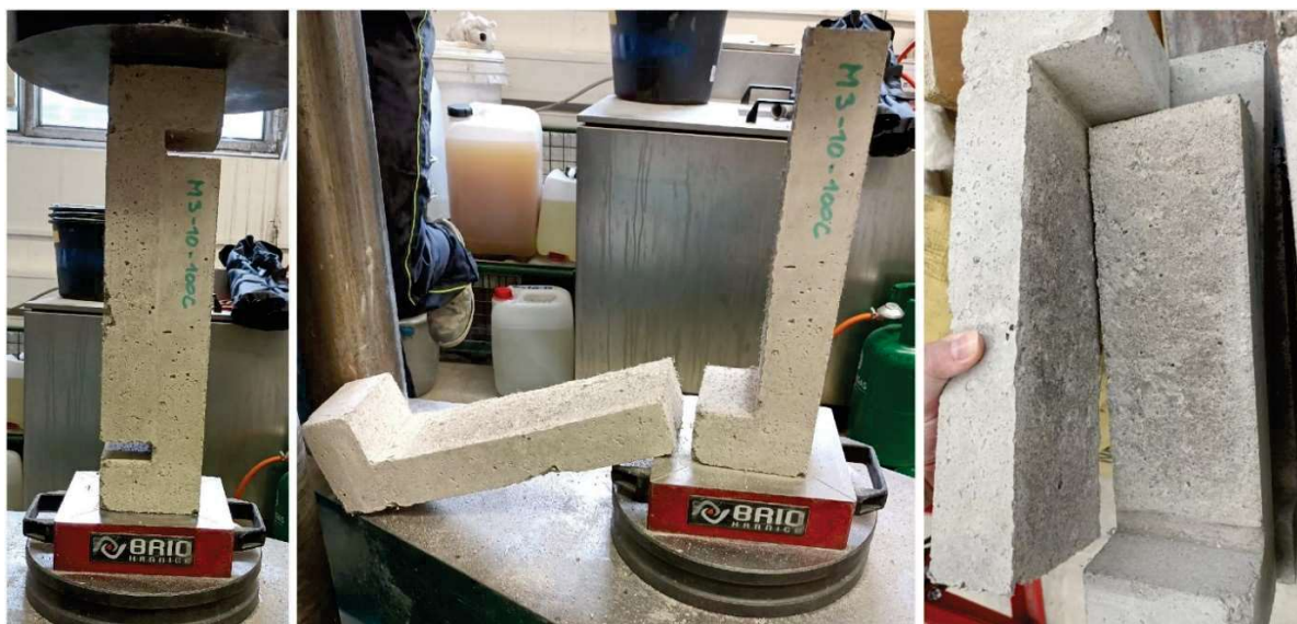
Obrázek 9: Typické porušení vzorku
