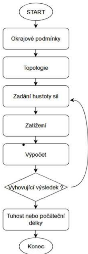
Obr. 5: Vývojový diagram lineární metody hustoty sil
