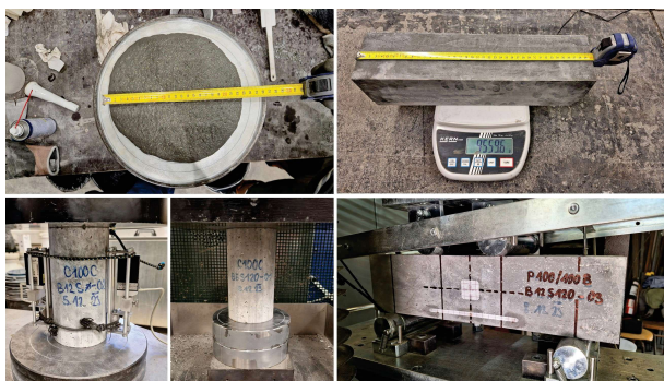
Obrázek 6: Zkoušky UHPC – konzistence (rozliti), objemová hmotnost, modul pružnosti, pevnost v tlaku, vlastnosti v ohybu.
