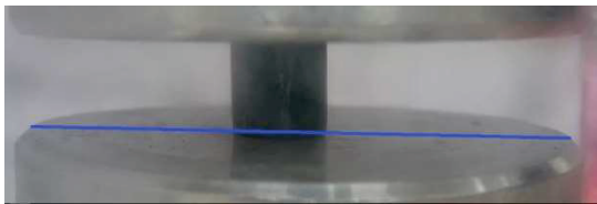
Obrázek 2 - Nerovné podstavy vzorku Serpentinu 1-5
