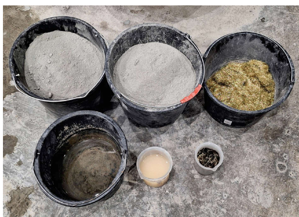
Obrázek 3: Složky pro výrobu UHPC.
