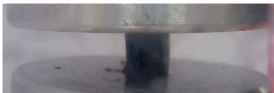
Obrázek 8 - Podrcení vyvýšené hrany vzorku Baryt 10-2
