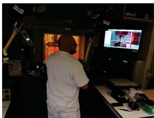
Obrázek 15 - Operátor horké komory při zakládání vzorku
