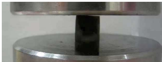
Obrázek 6 - Nerovné podstavy vzorku Baryt 10-2
