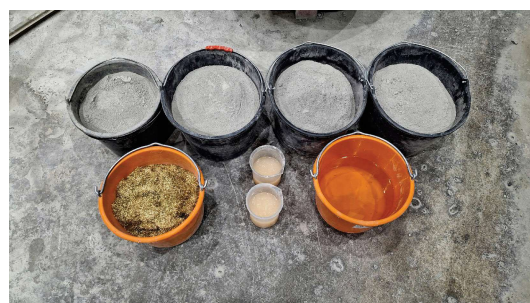
Obrázek 2: Složky pro výrobu UHPC.
