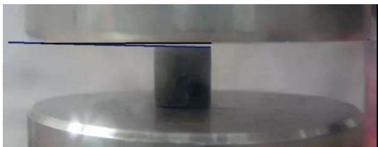
Obrázek 2 - Nerovné podstavy vzorku Serpentinu 1-5
