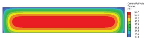
Obrázek 6: Teplotní analýza základové konstrukce – CEM II/B-S 32,5 R 400 kg/m 3
