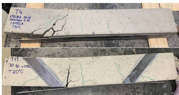
Obr. 5: Zesílené trámký zkoušené na čtyřbodový ohyb po porušení
