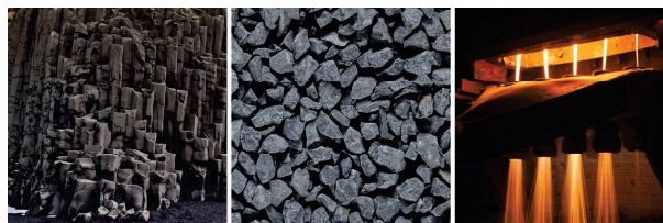
Obrázek 1: Čedič (hornina), čedičové kamenivo a tavený čedič.
