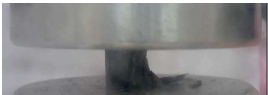
Obrázek 4 - Porušení vzorku Serpentinu 1-5
