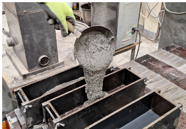
Obrázek 5: Lití zkušebních těles.
