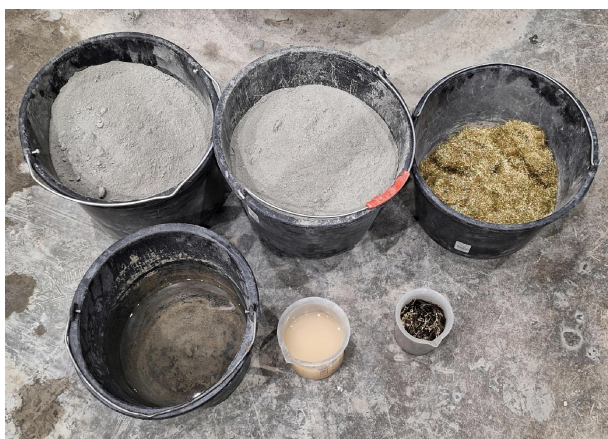
Obrázek 3: Složky pro výrobu UHPC.
