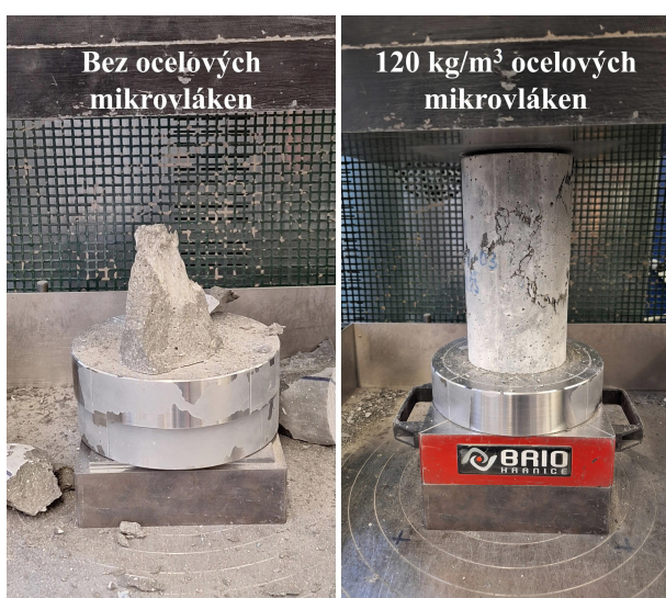
Obrázek 16: Porovnání způsobu porušení těles při zkoušce v tlaku.
