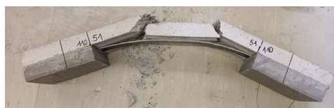
Obr. 4: Zesílený deskový prvek po porušení zkoušený na třibodový ohyb – Uspořádání experimentu 7 (Malínková 2025)
