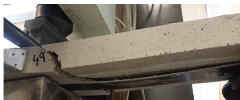
Obr. 3: Zesílený deskový prvek po porušení zkoušený na třibodový ohyb – Uspořádání experimentu 6 (Malínková 2025)
