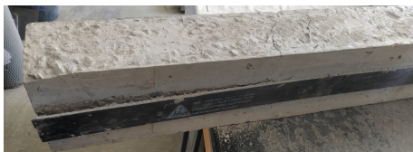
Obr. 1: Zesílené trámky po porušení zkoušené na čtyřbodový ohyb – Uspořádání experimentu 4 (Malínková 2025)
