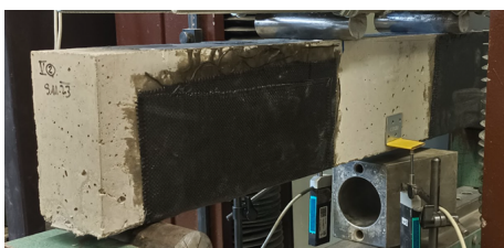
Obr. 2: Zesílené trámky po porušení zkoušené na čtyřbodový ohyb – Uspořádání experimentu 5 (Malínková 2025)
