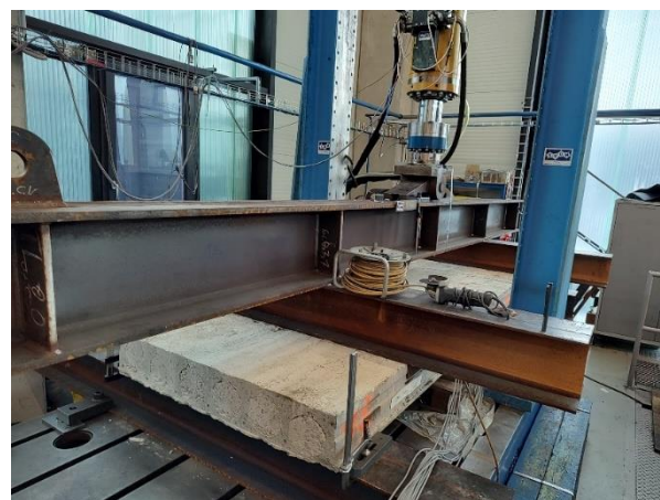
Obrázek 3: Fotografie zachycující upnutý panel v lisu před zahájením únavové zatěžovací zkoušky
