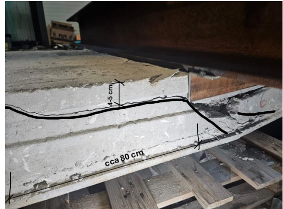
Obrázek 7: Fotografie panelu po dokončení únavové zatěžovací zkoušky (při kolapsu konstrukce) – Pohled v místě síly od hydraulického válce do pole
