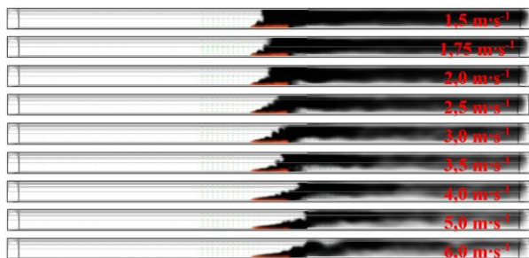
Obrázek 5: Šíření kouře (při 1,5 až 6,0 \text{m}\cdot\text{s}^{-1} ) v čase 180 s
