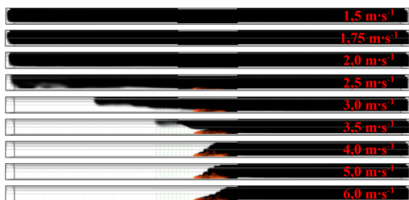
Obrázek 6: Šíření kouře (při 1,5 až 6,0 \text{m}\cdot\text{s}^{-1} ) v čase 480 s
