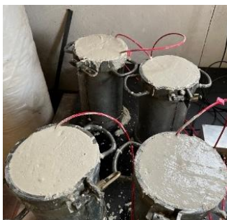
Obr. 2: Válce po ukončení betonáže
