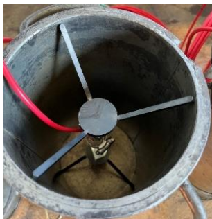
Obr. 1: Strunový tenzometr umístěný v ocelové formě
