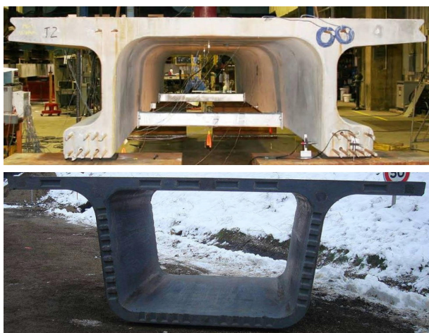
Obrázek 3: Příklady prvků z UHPC s průřezů nejasné klasifikace (Graybeal 2009, Delauzun et al. 2009).
