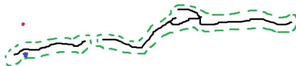
Obrázek 3: Zeleně vyznačena mez mezi přesností a chybovostí, Červeně chybné určení trhliny, modře nepřesné určení trhliny
