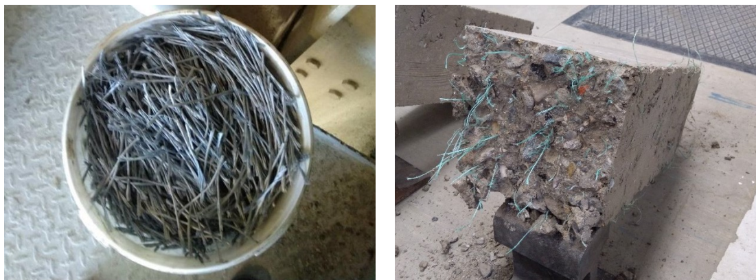
Obr. 5 Syntetická vlákna délky 110 mm (vlevo) a lomová plocha vláknobetonového trámce (vpravo)
