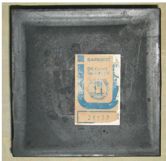
Obr.3 – Odzkoušené elastomerové ložisko – pohled (na ložisku je patrná plocha přenosu zatížení)
