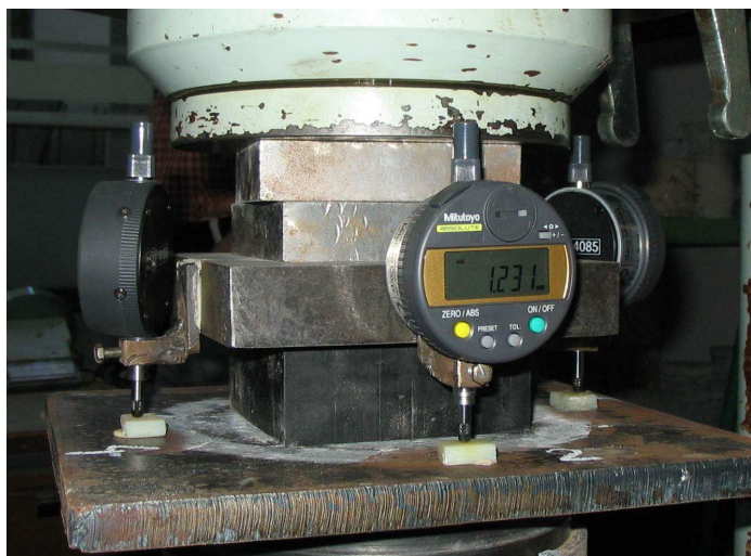
Obr.4 – Osazení elastomerového ložiska ve zkušebním lisu
