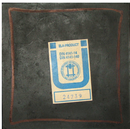
Obr.7 – Působící plocha elastomerového ložiska
